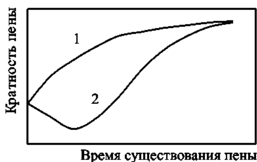
Рис. 2. Зависимость кратности пены от времени ее существования: 1 – верхний слой пены; 2 – слой пены на некоторой глубине
