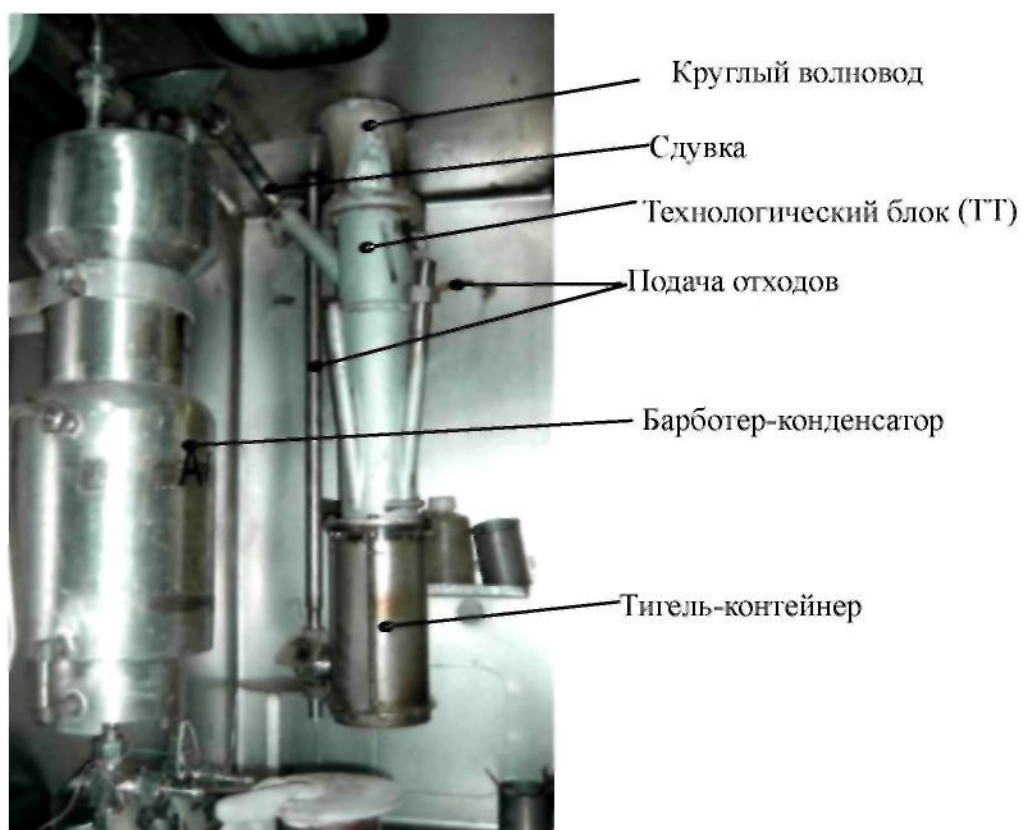
Рис. 4. Технологический блок с тиглем и барботер внутри вытяжного шкафа
