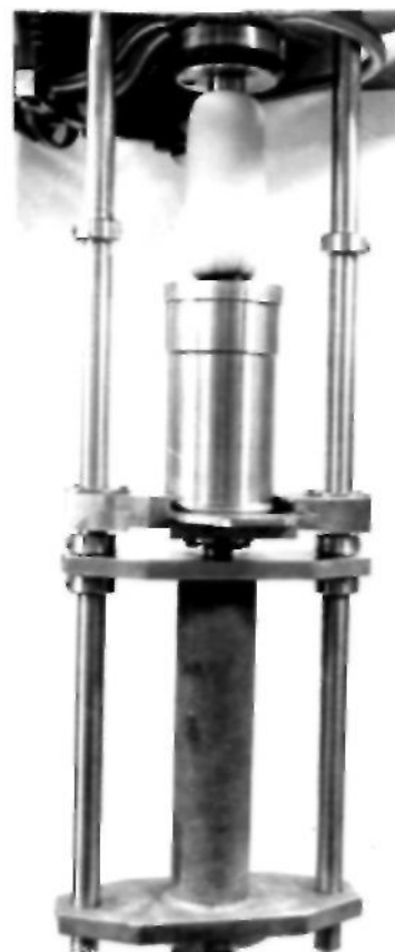
Рис. 2. Патронный фильтр "Капелла" 1 - подъемный столик, 2 - стакан, 3 - патрон, 4 - головка.
