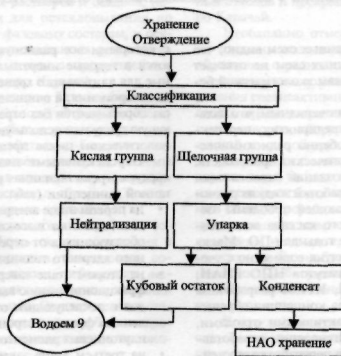
Рис. 3. Схема переработки среднеактивных отходов
